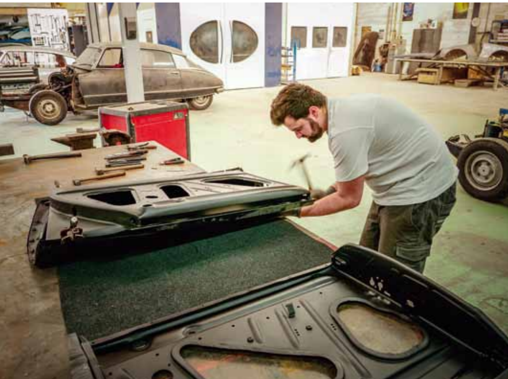
La corrosion se nichant dans le moindre recoin, les spécialistes de DSensation déshabillent intégralement chaque pièce avant de découper, former, souder, protéger...
